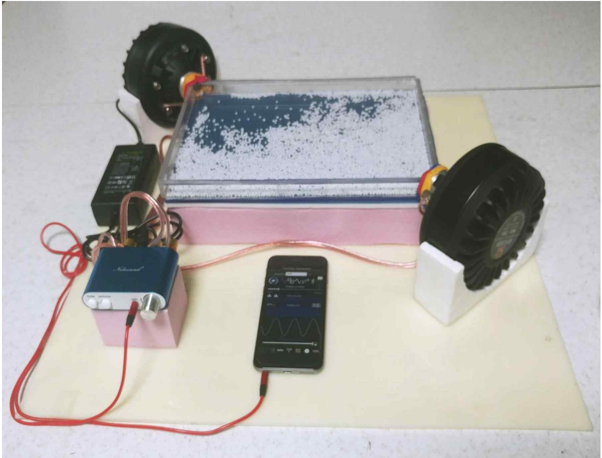
그림 12 2차원 정상파 가시화 장치 3차 작품(가로 28cm 세로 19cm, 스피커 2개)
